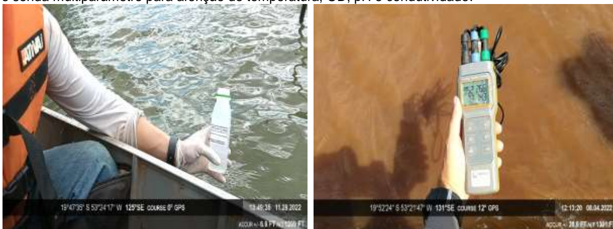
Figura 3 - Procedimentos de amostragem utilizando frasco de polietileno para análises físico-químicas e sonda multiparâmetro para aferição de temperatura, OD, pH e condutividade.
