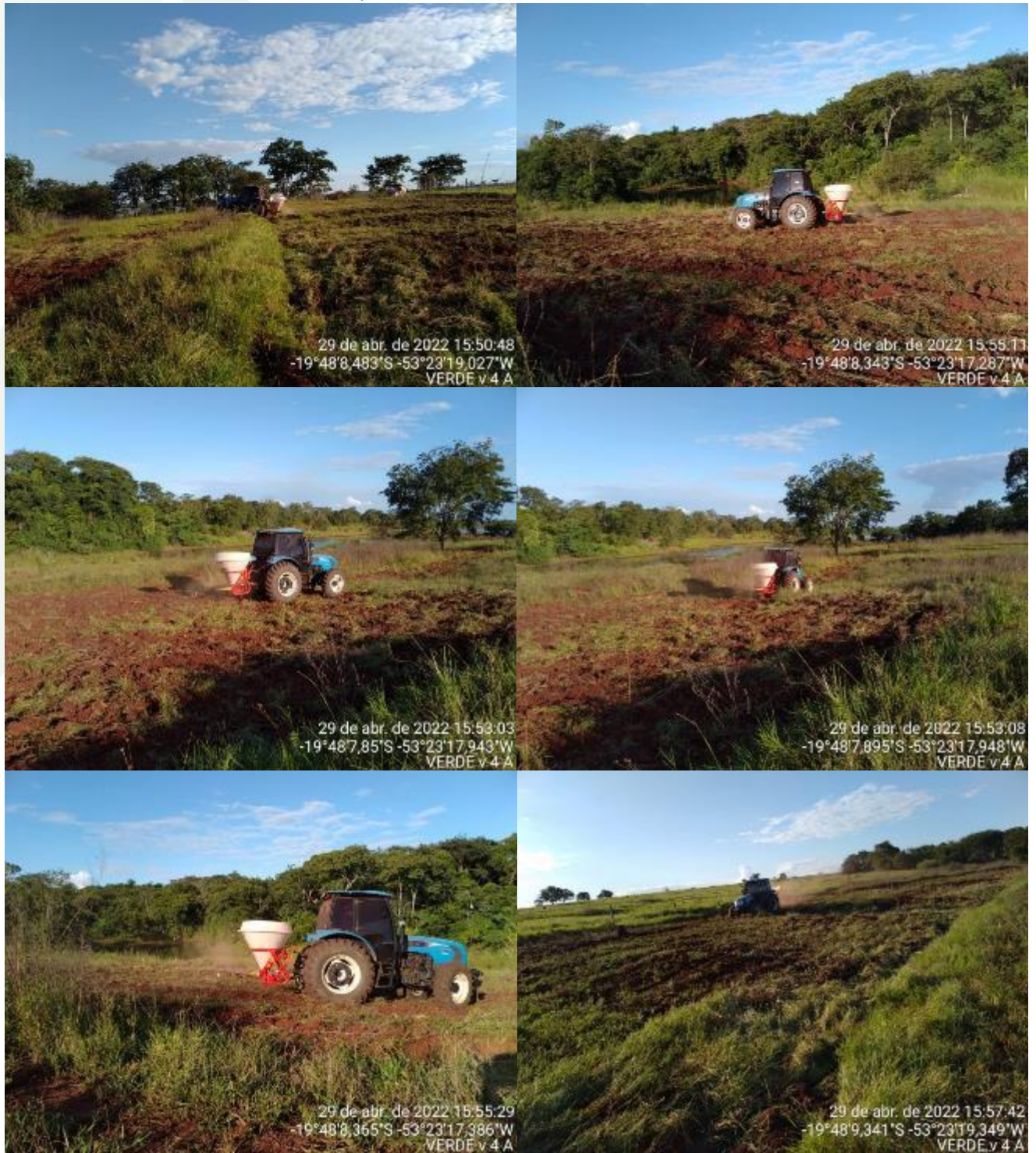
Figura 7. Plantio a lanço de sementes nativas sendo realizado com o uso de Vincon.
